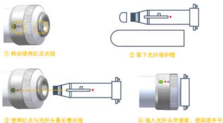
图 2-3 QBH 与光纤连接方法
