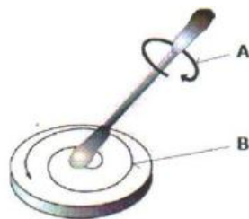
A 棉签转动方向 B 圆弧运动清洁镜片
