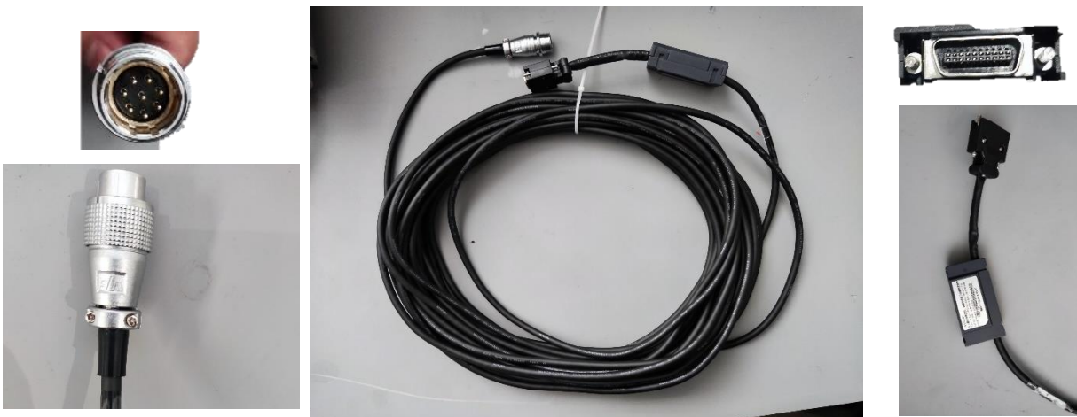
图 3.5 GF102 摆动轴 A (B) 轴编码线示意图
