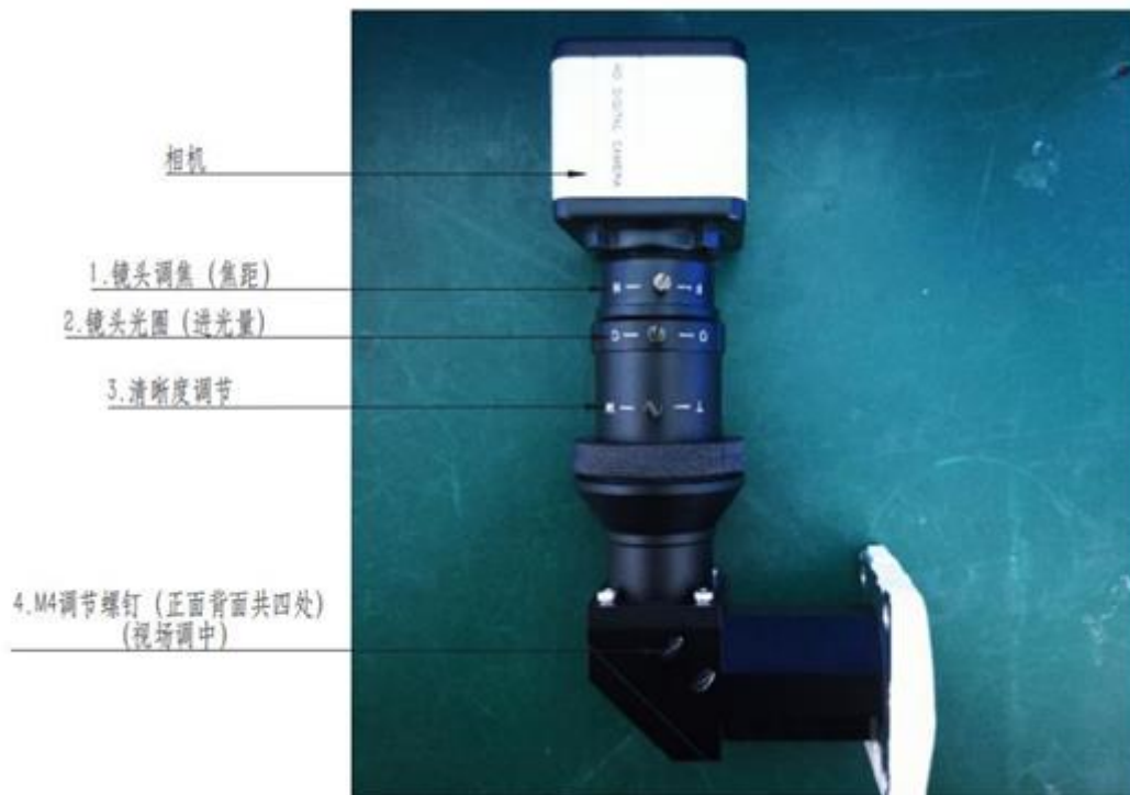
图 12 CCD 结构图示
