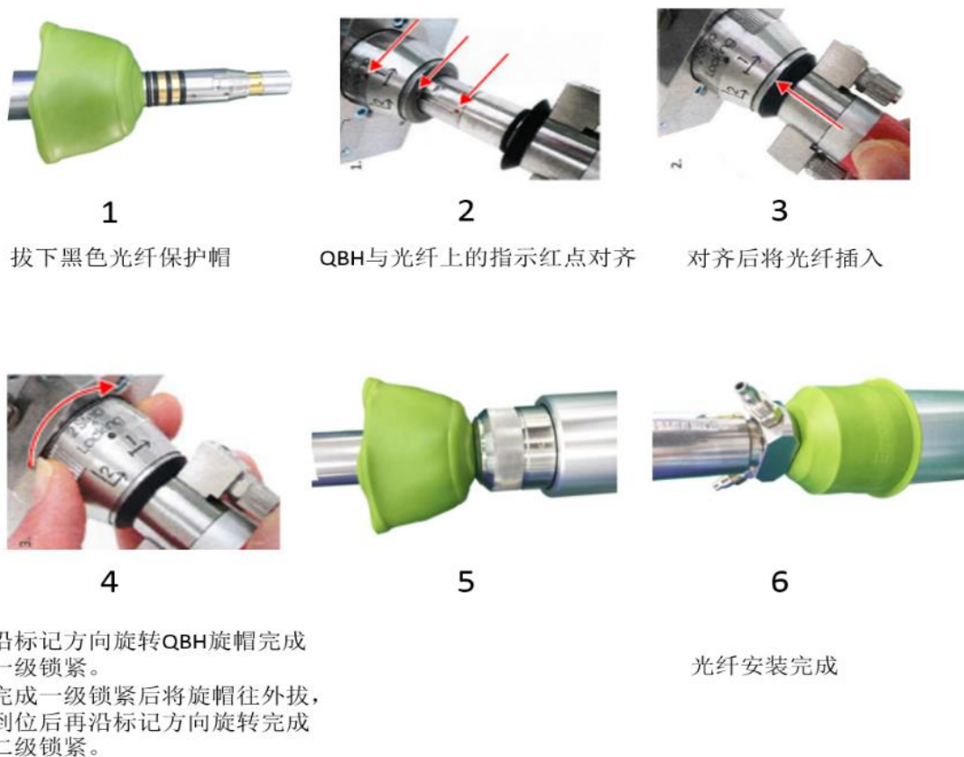
图 9 QBH 与光纤连接方法
