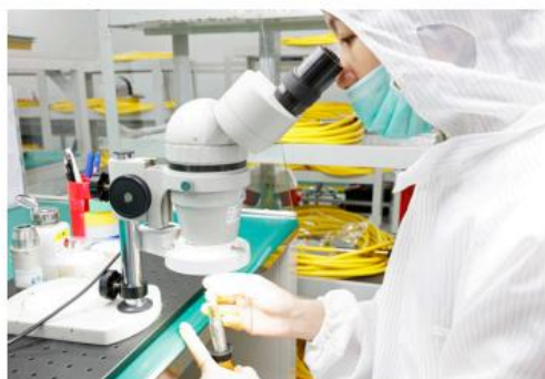
显微镜上安装光纤连接器
