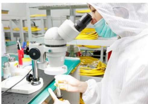
显微镜上安装光纤连接器
