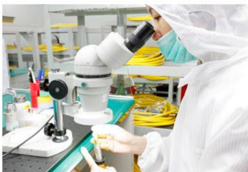
显微镜上安装光纤连接器
