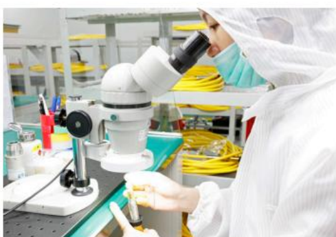
显微镜上安装光纤连接器
