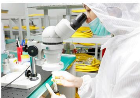
显微镜上安装光纤连接器
