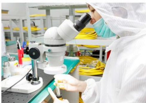
显微镜上安装光纤连接器
