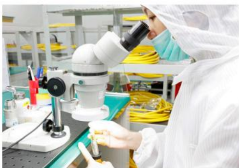
显微镜上安装光纤连接器
