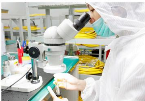
显微镜上安装光纤连接器
