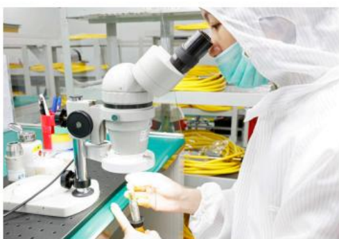
显微镜上安装光纤连接器
